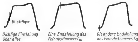
Bild 63. Wirkungsweise der Oszillator-Feinabstimmung bei Metz
