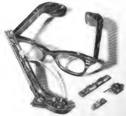
Die Hörbrille und ihr Aufbau. Mikrofon, Verstärker und Hörer befinden sich im Brillengestell
